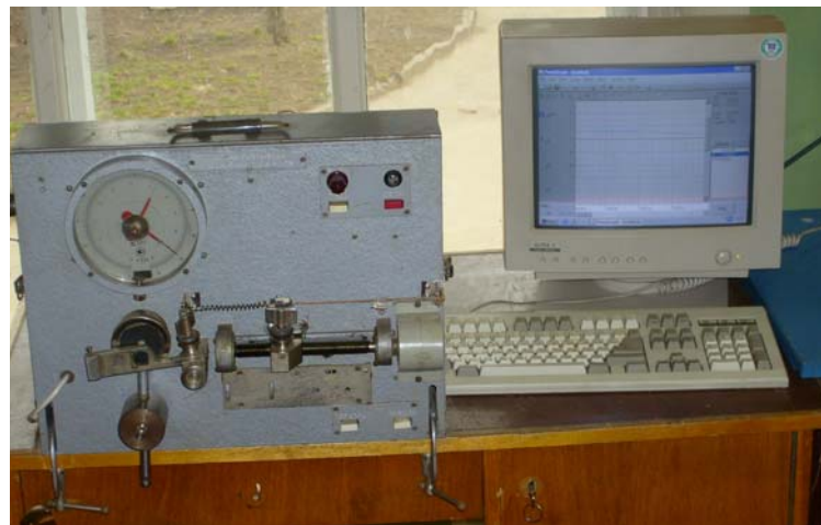
Рис. 2. Общий вид информационно-измерительной системы на базе разрывной машины РМП-1
